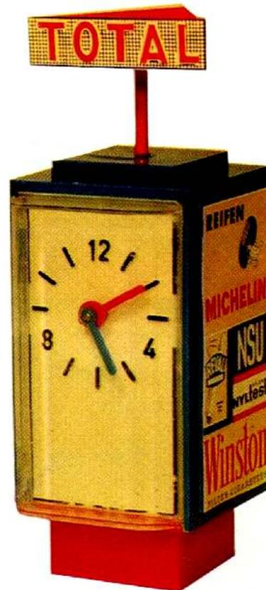
**Elektrischer Rundenzähler** Nr. 4901. Um die Runden deutlich erkennen zu können, wurde für die Rundenzählanlage ein Uhrzeigersystem entwickelt. Bei jeder Runde schaltet ein Zeiger  $\frac{1}{12}$ , also 5 Minuten, weiter. Ein roter und ein blauer Zeiger gilt jeweils für je eine Spur.
