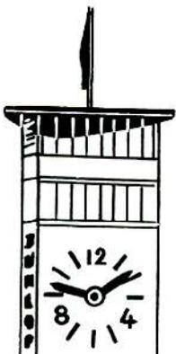
Um die Runden deutlich erkennen zu können, wurde für die Rundenzählanlage ein Uhrzeigersystem entwickelt. Bei jeder Runde schaltet ein Zeiger  $\frac{1}{12}$  also 5 Min. weiter. Ein roter und ein blauer Zeiger gilt jeweils für je eine Spur.
