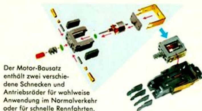
Der Motor-Bausatz enthält zwei verschiedene Schnecken und Antriebsräder für wahlweise Anwendung im Normalverkehr oder für schnelle Rennfahrten.
